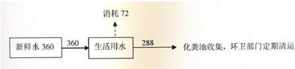
图 2-4 项目水平衡图 m³/a
